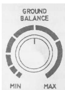
Установите MODE на GROUND BALANCE, затем настройте кнопку поворота баланса грунта.
